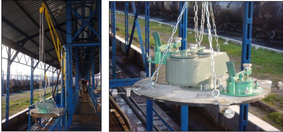
სურათი 3.2.1. 5. ჰერმეტიზაციის სარქველები № 5 სარკინიგზო ესტაკადაზე
