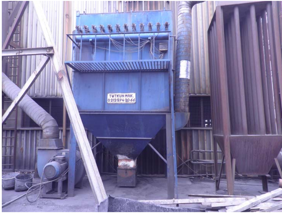
სურათი 2. სტაციონარული ღუმელის აირმტვერნარევის გამწმენდი ფილტრი.
